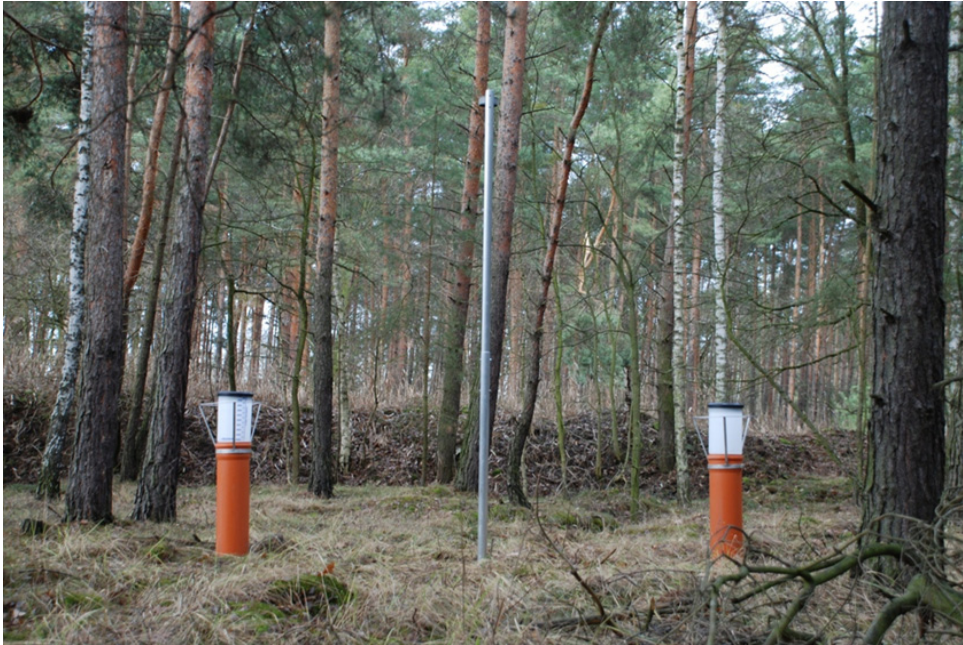
Abbildung 32: Aufbau des Messpunktes 290 K (Betrieb 1): LÖLF-Sammler mit Vogelvergrämungsringen sowie Messmast für Passivsammler
