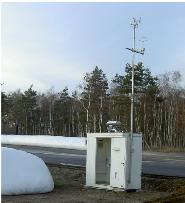
b) DOAS-Container mit Empfänger und Meteorologie
