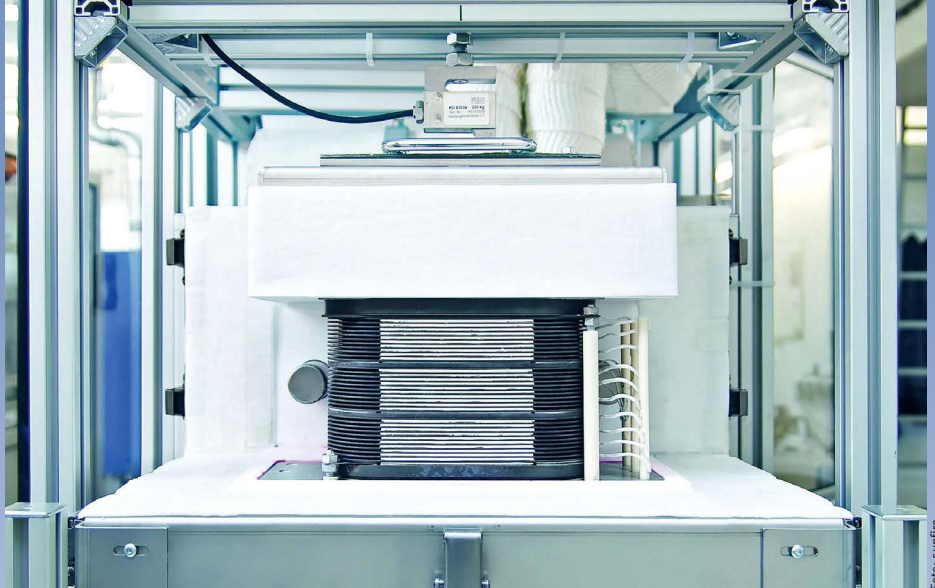
Ein Brennstoffzellen-Stack von sunfire soll in Heizgeräten arbeiten und herkömmliche Technik ablösen.
