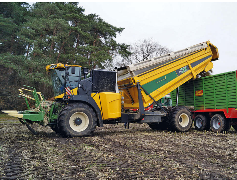
Der Bunkerhächsler im Einsatz im niedersächsischen Wulfsen. Das Entladen von 42 Kubikmetern Silage erfolgt in nur 75 Sekunden.
