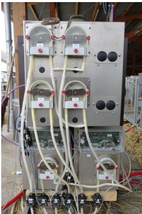
Abbildung 2: Einrichtung zum Paralleltrinken an den sechs Tränkstationen in den Einzeliglus
