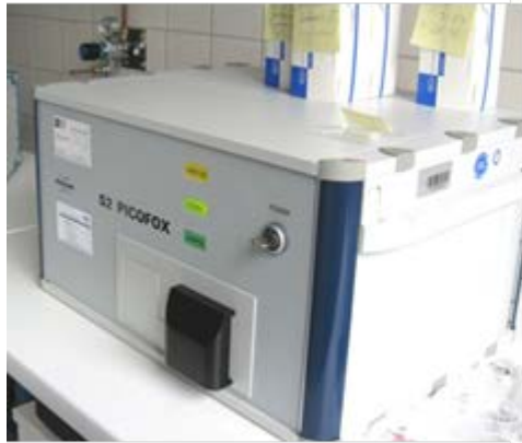
Abbildung 5: Bruker S2 PICOFOX TXRF-Instrument (links); TXRF-Spektrum von Saharastaub (rechts)
