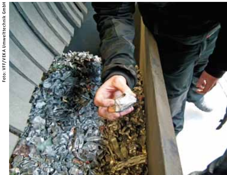
Teile von Aluminiumfenstern beim Recycling.
