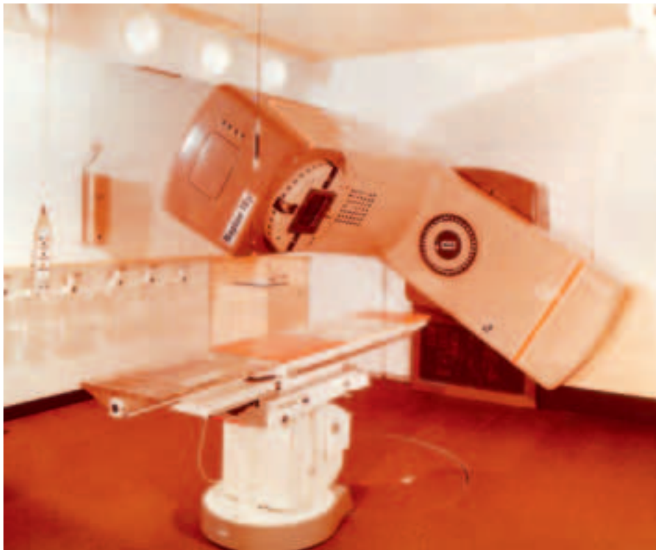
Das Grunddesign von Linearbeschleunigern hat sich über die Jahrzehnte kaum verändert: Der erste Linearbeschleuniger im Krankenhaus Küchwald in Karl-Marx-Stadt: ein Neptun 10p (ZdAJ Wierk) aus polnischer Fertigung nach einer Lizenz der französischen Firma CGR. Am 2. Januar 1980 wurde die erste Bestrahlung mit diesem Linearbeschleuniger zur Krebsbehandlung durchgeführt. Das Ersatzgerät gleicher Bauart wurde erst am 1. Januar 1998 außer Dienst gestellt.
