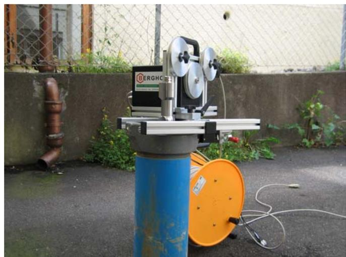
**Abbildung 3: Thermo-Flowmeter: Messequipment**
