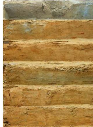
**Abb. 3: Schichtenaufbau kontaminiertes Substrat
