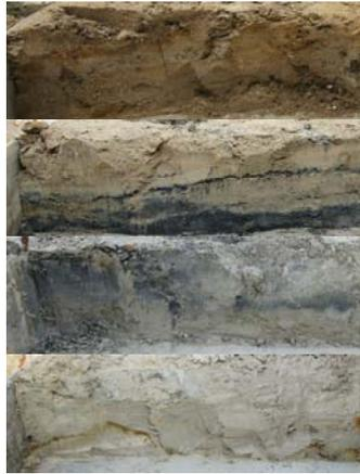
**Abb. 2: Schichtenaufbau kontaminiertes Substrat
