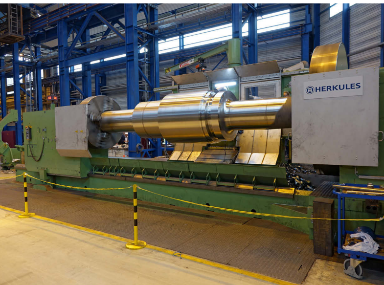
Die neue Drehmaschine der Walzengießerei Coswig macht die Produktion von Hohlwellen für Windkraftanlagen möglich.
