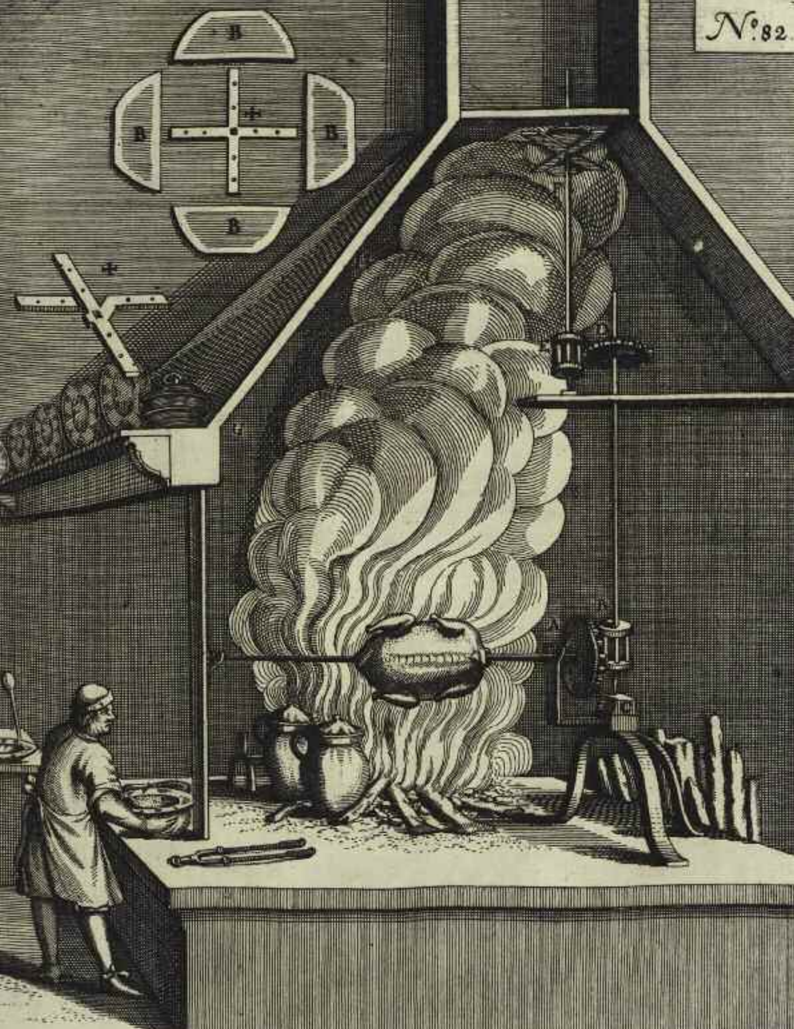
1 // Mechanischer Bratenspieß, aus: Georg Andreas Böckler: Theatrum Machinarum Novum. Das ist: Neu-Vermehrter Schauplatz der Mechanischen Künsten, Nürnberg 1661, Tafel 82
