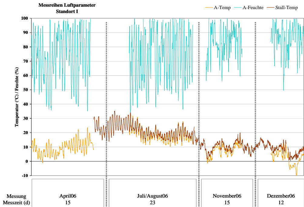
Abbildung 13: Verläufe der Außenlufttemperatur und -feuchte sowie Stalllufttemperatur während der Messreihen am Standort 1
