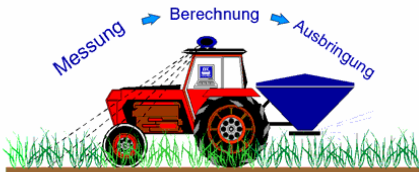
Abbildung 19: Konzept des N-Sensors zur Ermittlung angepasster Düngermengen (aus: LUDOWICY et al. 2002)
