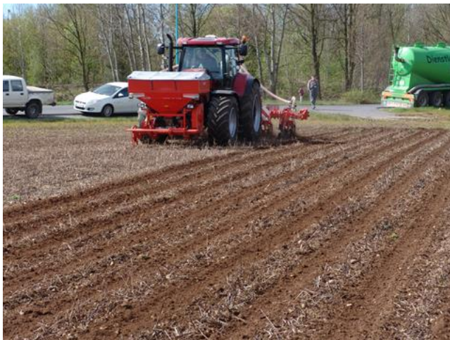
Abbildung 77: Streifenbearbeitung mit dem Kuhn-Striger mit gleichzeitiger Unterflurdüngung (225 kg DAP/ha)
