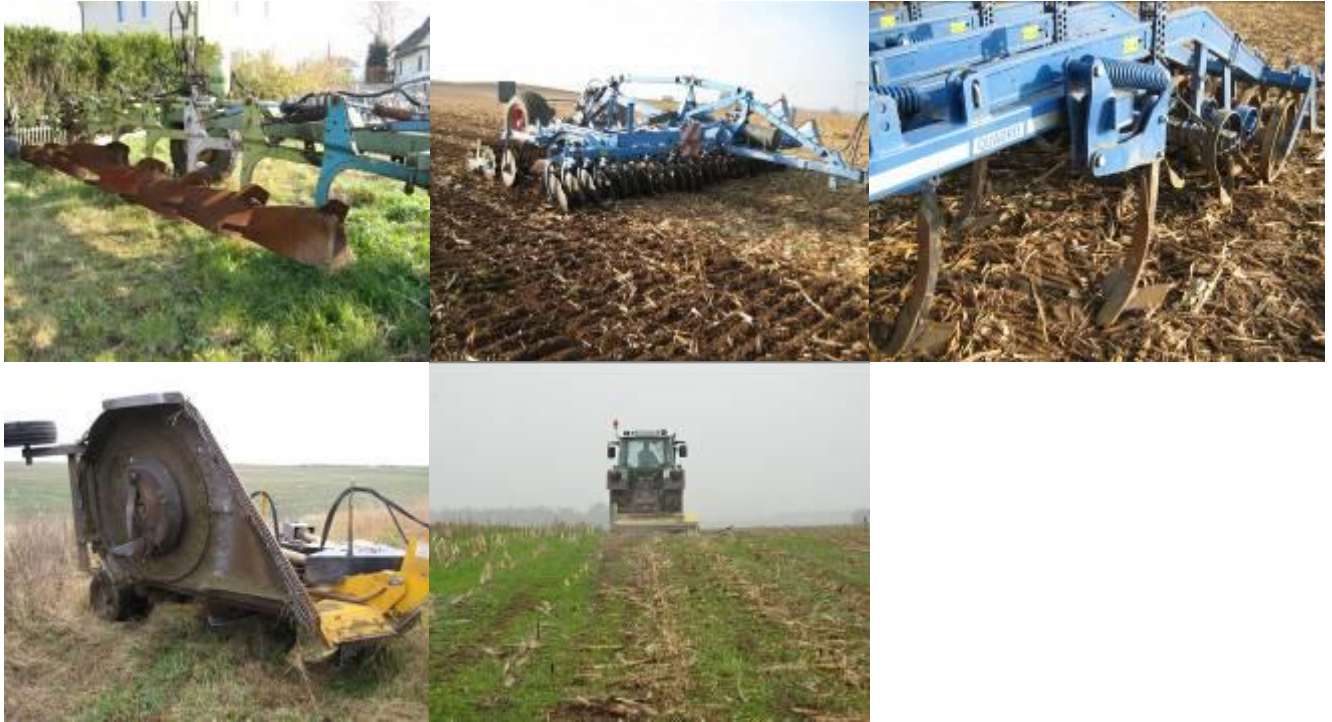
Abbildung 2: Bodenbearbeitungsgeräte (von oben links nach unten rechts: Pflug, Scheibenegge, Grubber, Sichelmulcher, Schlegelmulcher)
