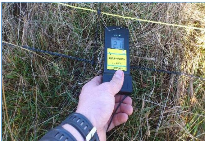
**Abbildung 19: Messung der Spannung**
