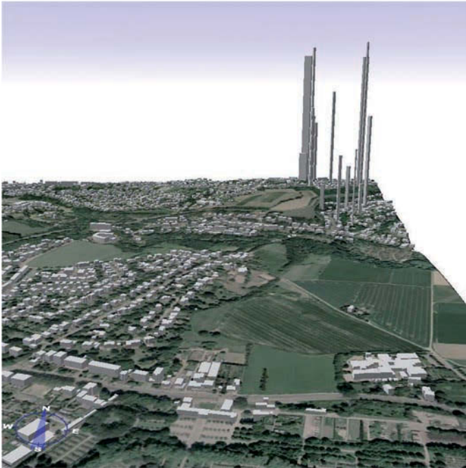
Abb. 2: Fehlerhafte Laserscanningdaten (Quelle: Bezirksregierung Köln)
