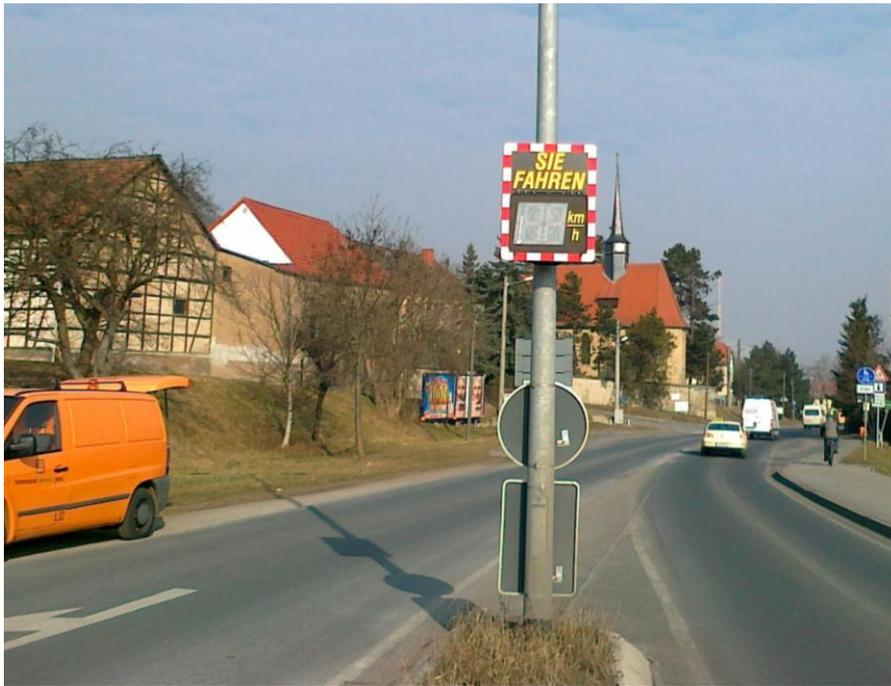
**Abbildung 25: Geschwindigkeitsmesstafeln an lärmkritischen Straßenabschnitten in Jena**
