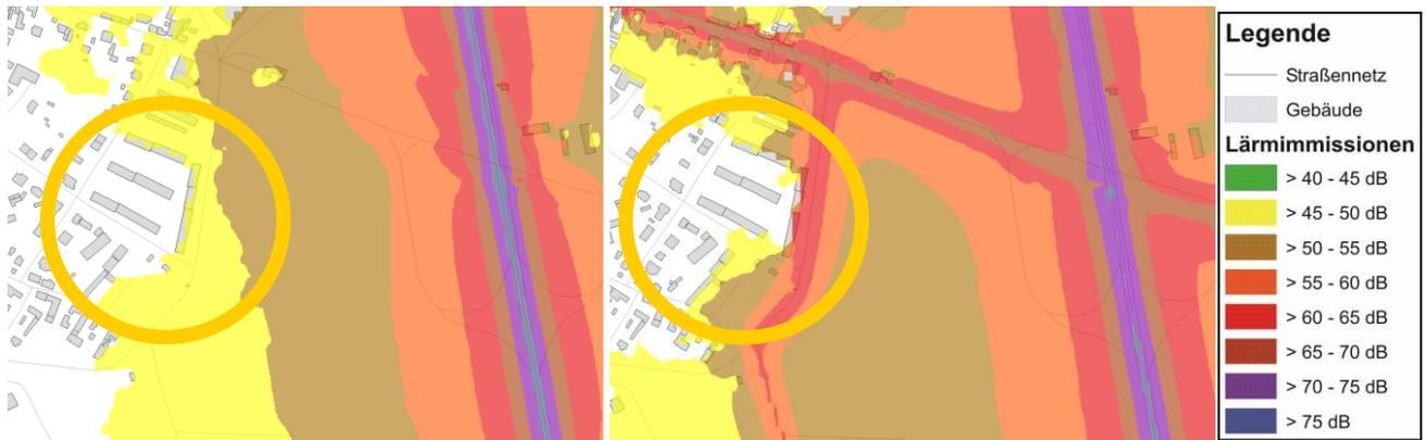
**Abbildung 3a/b: Vergleich der Belastungssituation am Plattenbau Schulstraße/ Straße „Am Sinter“ in Radeburg, links Belastung nur durch die BAB A 13/ rechts durch das gesamte Hauptverkehrsnetz ( $L_{NIGHT}$ )**
