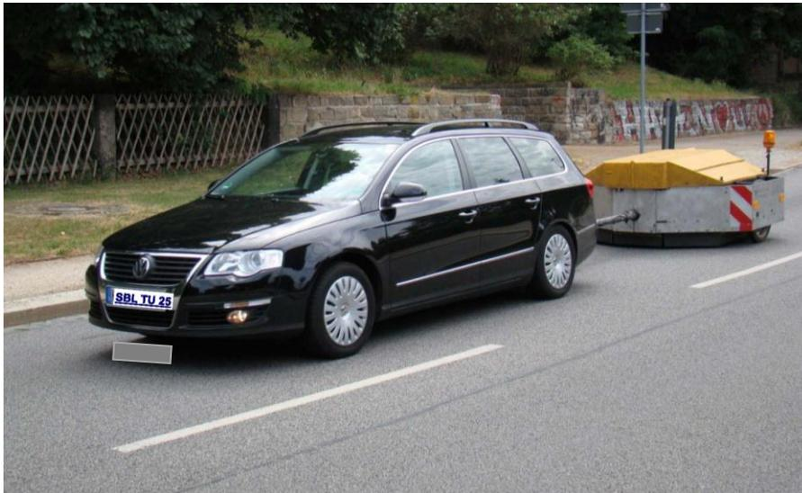
**Abbildung 18: Messfahrzeug zur Erfassung der Lärmemission nach CPX-Methode**
