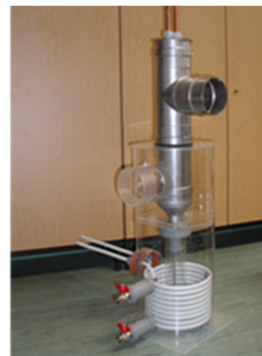
Abbildung 17: Brennwertwäscher [TU Dresden]
