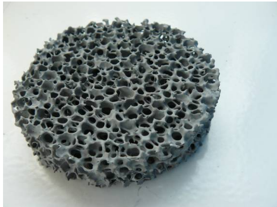
Abbildung 60: SiC-Schaumkörper mit einer Höhe von 2,5 cm und einem Durchmesser von 9 cm.
