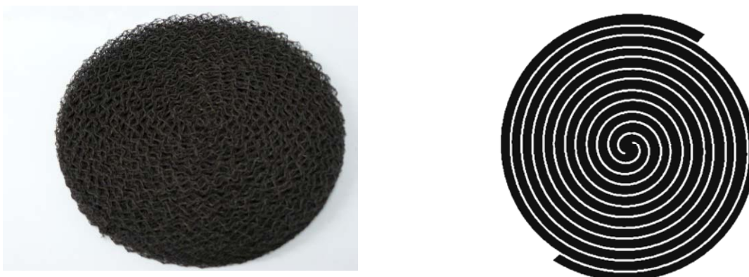
Abbildung 52: Foto der Katalysatorscheibe (links), bestehend aus einem Drahtgewebband, welches mit Platin beschichtet, auf halber Länge gefaltet und dann spiralförmig aufgewickelt wurde. Rechts ist die spiralförmige Wicklung noch einmal schematisch dargestellt.
