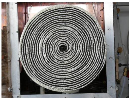
Abbildung 111: Foto der Katalysatorscheibe, nachdem das Isolierband mit eingewickelt wurde.
