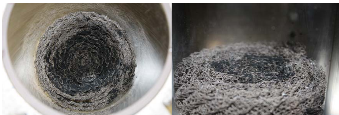
Abbildung 92: Fotografien des mit Ruß beladenen Drahtgeflechtkatalysators nach der Bestrahlung mit Mikrowellen. Links: Nach Bestrahlung mit einer Mikrowellenvorlaufleistung von max. 1100 W. Rechts: Nach Bestrahlung mit einer Mikrowellenvorlaufleistung von max. 1400 W.
