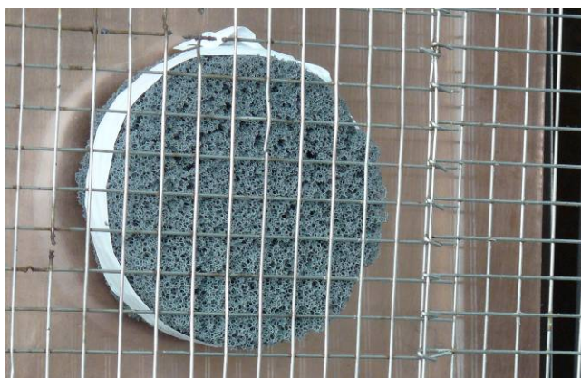
Abbildung 57: Al/Al 2 O 3 -Schaum zwischen der spannungsführenden Kupferelektrode und der geerdeten Gitterelektrode. Die Maschenweite des Gitters beträgt 11 mm.
