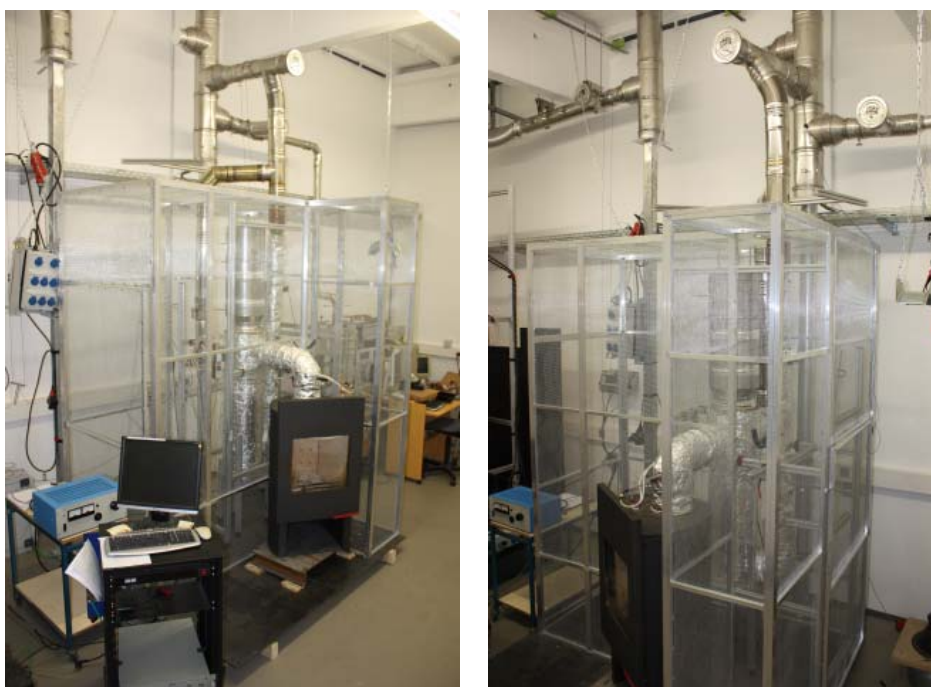
Abbildung 108: Technikumsversuchsanlage mit faradayschem Schutzkäfig
