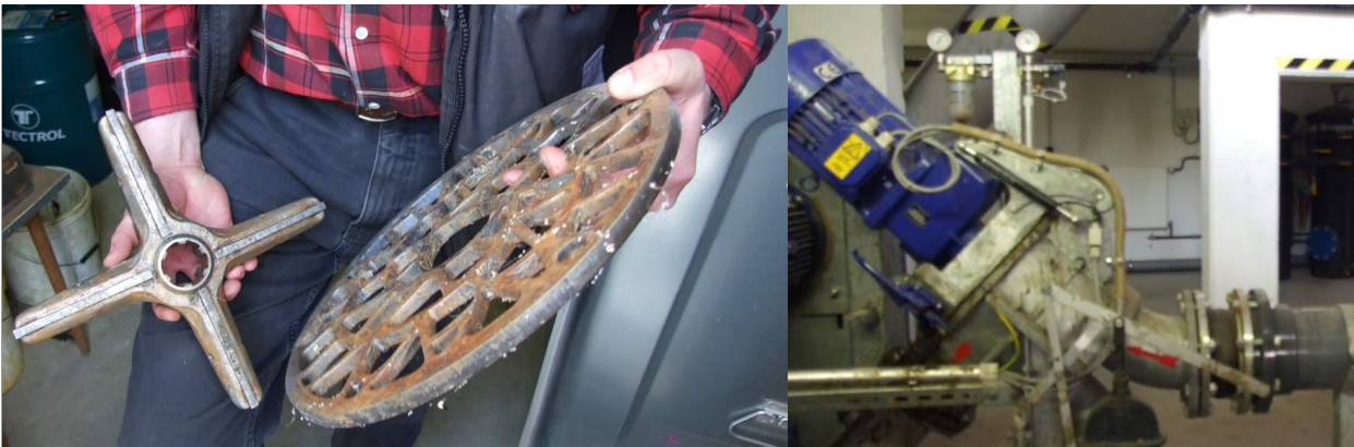
Abbildung 6-5: Nass-Zerkleinerer (hier RotaCut von Vogelsang): Schneidmesser und Schneidsieb (links) und das in ein Pump- und Leitungssystem eingebaute Gerät (rechts) (Foto: ATB)
