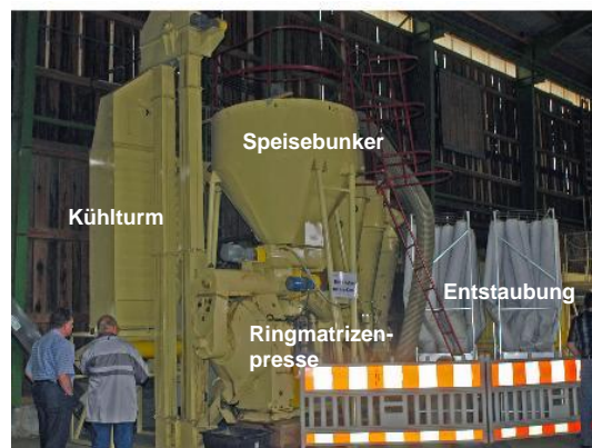
Abbildung 5-13: Anlage zur Pelletierung von Halmgut bei der Firma Agrarhandel Müller GbR in Dietingen-Böhringen (Foto: [117])
