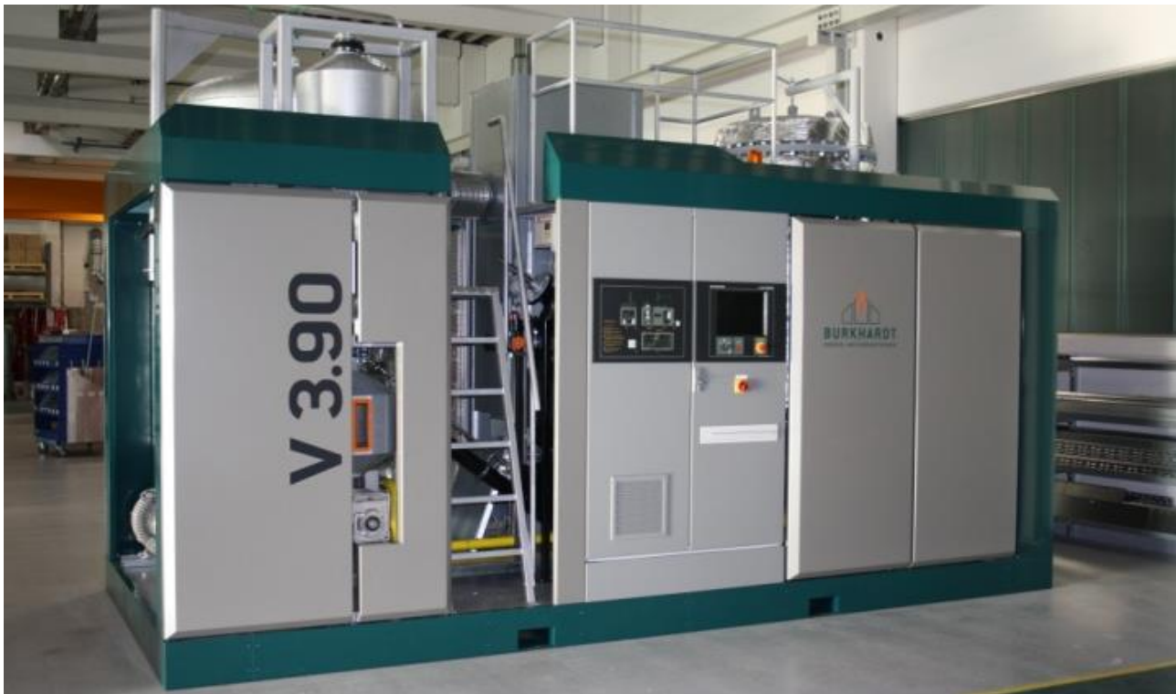
Abbildung 7.5 Holzvergaser Burkhardt GmbH 180 kW el (© Burkhardt GmbH).
