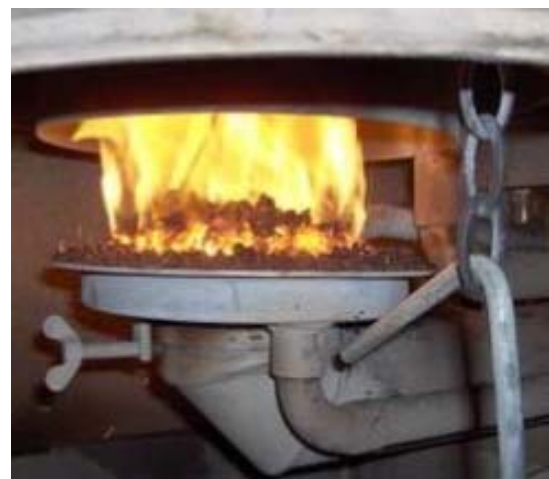
Abb. A-0-4: Funktionsskizze des Pelletti II SR 203 (oberes Bild), Prinzip der Brennstoff- und Luftzufuhr sowie der Ascheabführung im Feuerraum (unteres Bild links), Brennerretorte mit Pellets (Bild unten rechts) /2/, /172/
