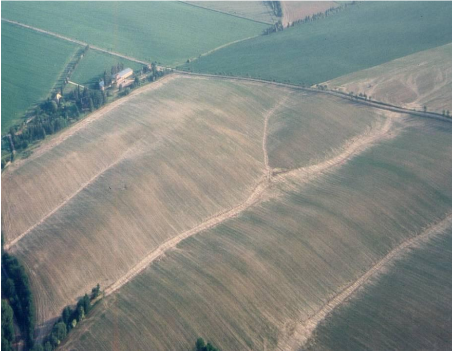
Abbildung 2: Linienhafte Bodenerosion entlang von reliefbedingten Abflussbahnen in einem Acker- schlag (Foto: Fred Franzke)
