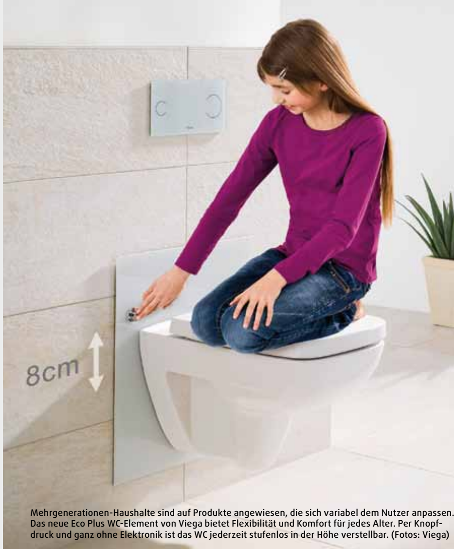
Per Knopfdruck wird die Sitzhöhe des WCs im Bereich von 40 Zentimetern bis 48 Zentimetern jederzeit individuell eingestellt. Die dafür notwendige bewegliche aber stromlose Technik verschwindet hinter einem Einscheibensicherheitsglas. Die Betätigungspalten sind frei aus dem Viega Programm wählbar.
