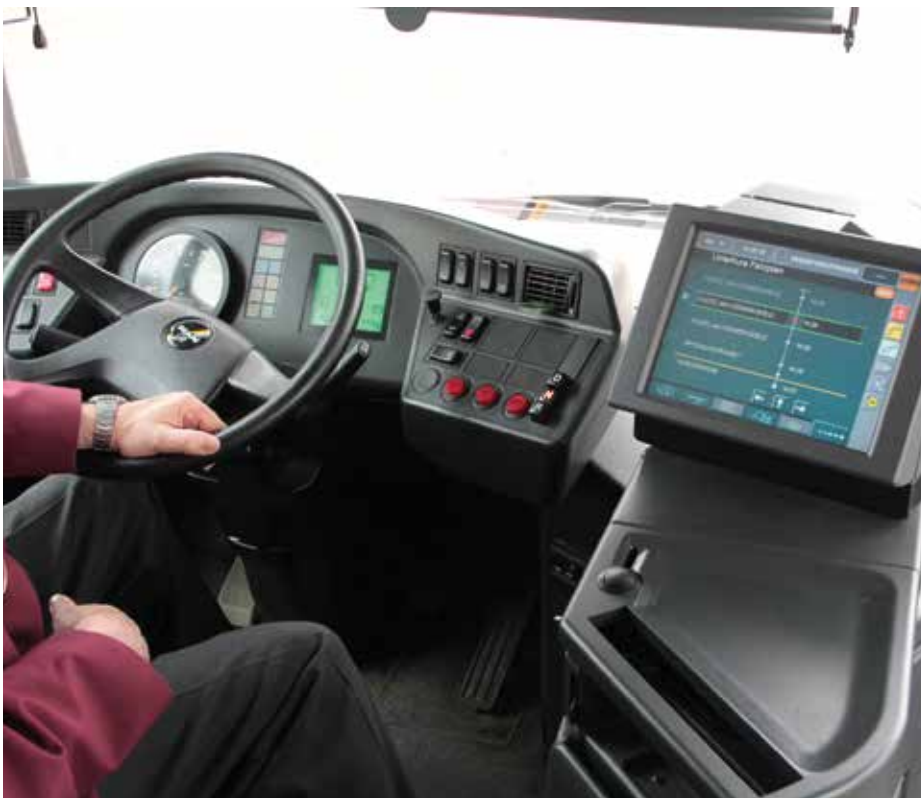
Mit der Erneuerung des Betriebsleitsystems werden alle Fahrzeuge mit neuen Bordrechnern ausgerüstet.
