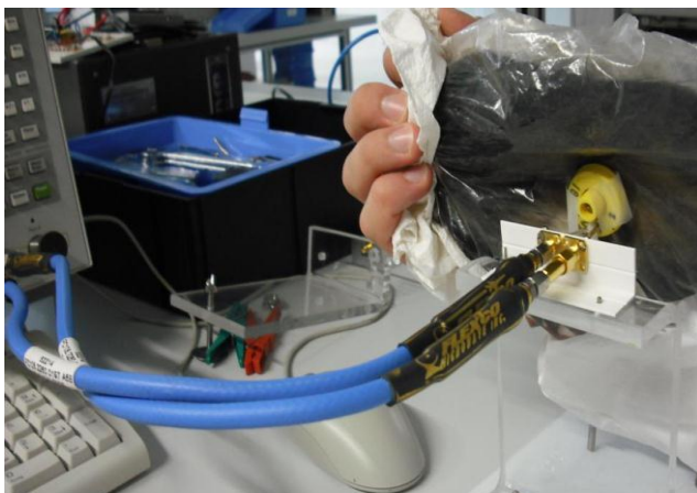
Abbildung 13: Die Ohrmarken-Labormuster wurden für erste "praxisnahe" Tests an Kuhohren von Schlachttieren angebracht und messtechnischen Untersuchungen unterzogen. Kabelgebundene Messung der Labormuster zum Vergleich der Mustereigenschaften mit den Simulationsergebnissen führten zu erstem Redesign.
