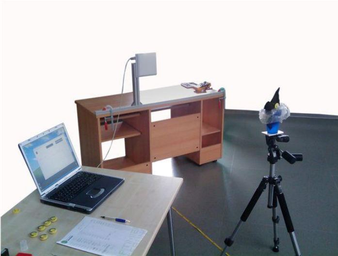
Abbildung 14: Funkstrecke zur Bestimmung der erreichbaren Lesereichweite mit einer 16 dBi-Readerantenne und den Labormustern auf der Grundlage der Simulation nach erstem Redesign
