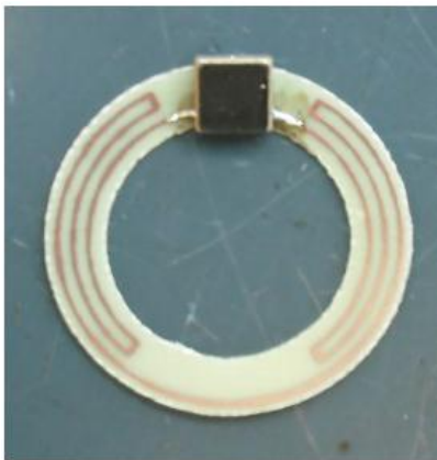
Abbildung 11: Auf der Grundlage der Simulationsergebnisse wurden erste Antennenmuster hergestellt und mit einem SAW-Transponderchip im Primärgehäuse versehen.
