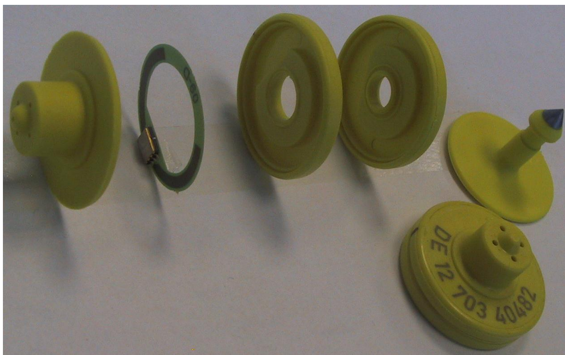
Abbildung 17: Aufbau einer SAW Ohrmarke
