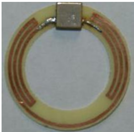
Abbildung 16: Umgestaltung der Transponderantenne von einem Faltdipol in einen Dipol
