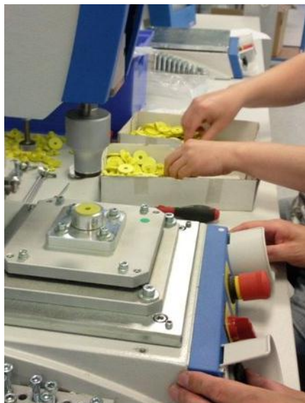
Abbildung 18: Ultraschallschweißen der Agro-SAW-IDENT Demonstrator-Ohrmarken
