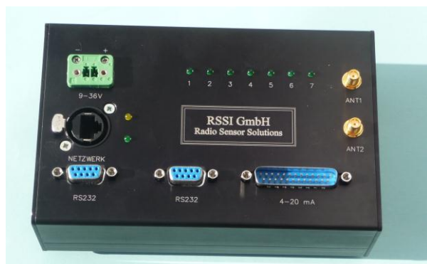
Abbildung 20: Der ASI-Reader im Gehäuse mit Anschlüssen für Schnittstellen und zwei Antennen
