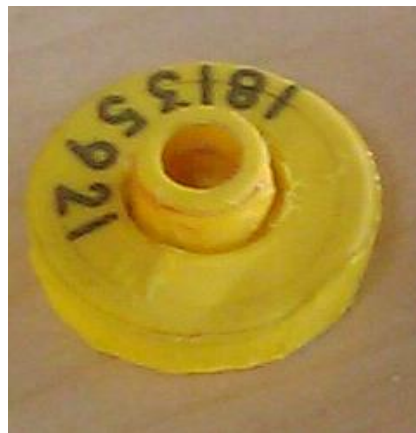
Abbildung 12: Die Antennenmodule wurden in Mustergehäuse elektronischer Rundohrmarken eingesetzt. Es entstanden die ersten Labormuster der SAW IDENT-Ohrmarken.
