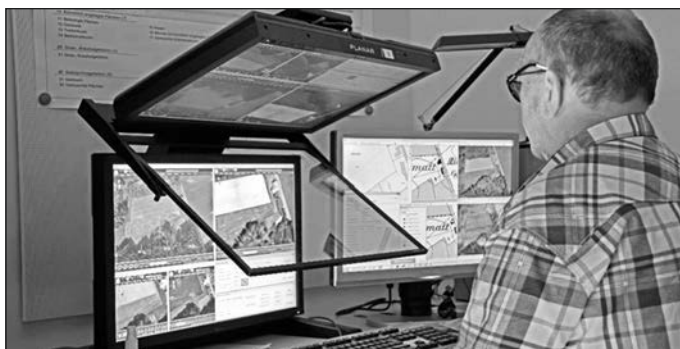
Abb. 3: Bildinterpretierer bei der Arbeit an einer 3D-Bildstation mit Zusatzbildschirm (Quelle: BFS – Arealstatistik 2015; Foto: M. Brügger, BFS)
