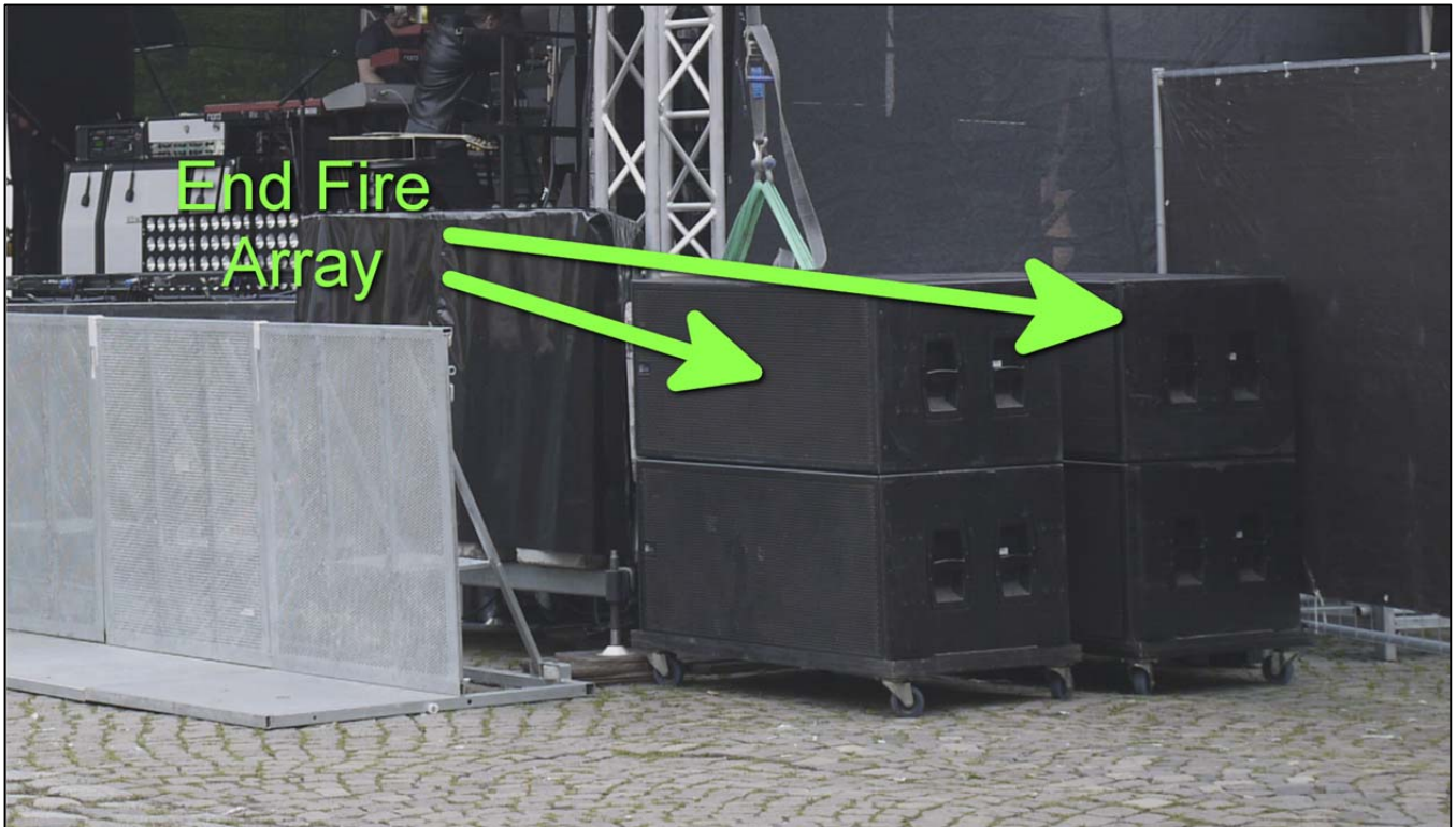
Abbildung 31: Gestackte Subwoofer in End-Fire-Anordnung (links und rechts der Bühne) an einer Großbühne
