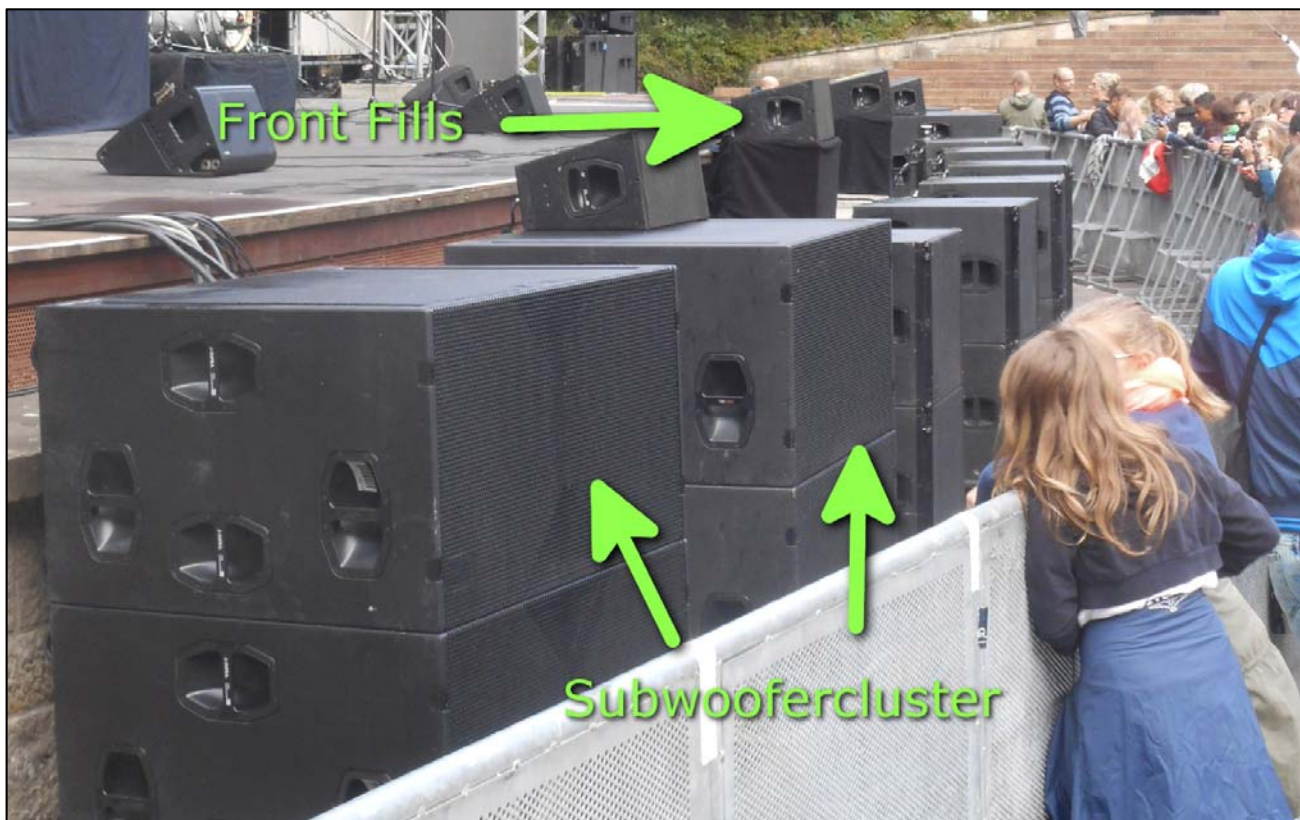
Abbildung 30: Subwoofer in gekrümmter Zahnlücken-Anordnung mit Front Fills an einer Großbühne
