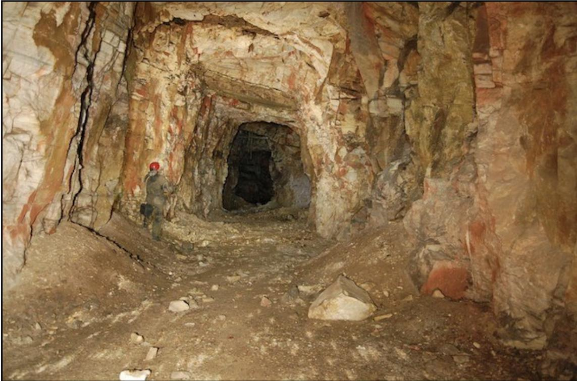
Wie oben schon zu lesen stand, hat schon das staatliche Werk mehrere Strecken durch den Straßen-Sicherheitspfeiler hindurch ausgelängt. Sie sind bei rund 5 m Breite bis zu 8 m hoch.
