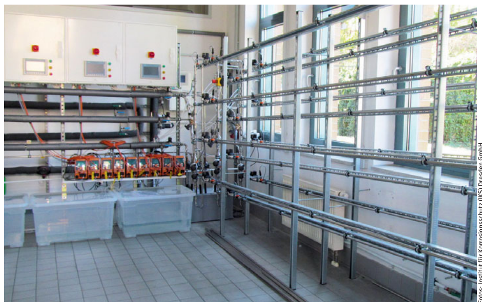
Die komplexen Prüfstände sind einem Haushaltsanschluss wie beispielsweise in einer Küche nachempfunden, indem genormte rohrförmige Prüfkörper einen automatisierten Wechsel langer Stagnations- und kurzer Spülphasen durchlaufen.
