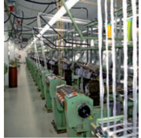
Produktionsanlagen im Textilunternehmen F.A. Schurig in Großröhrsdorf. Beleuchtet werden die Hallen mit moderner LED-Technik. Über Sensoren wird der Einsatz von Licht geregelt.
