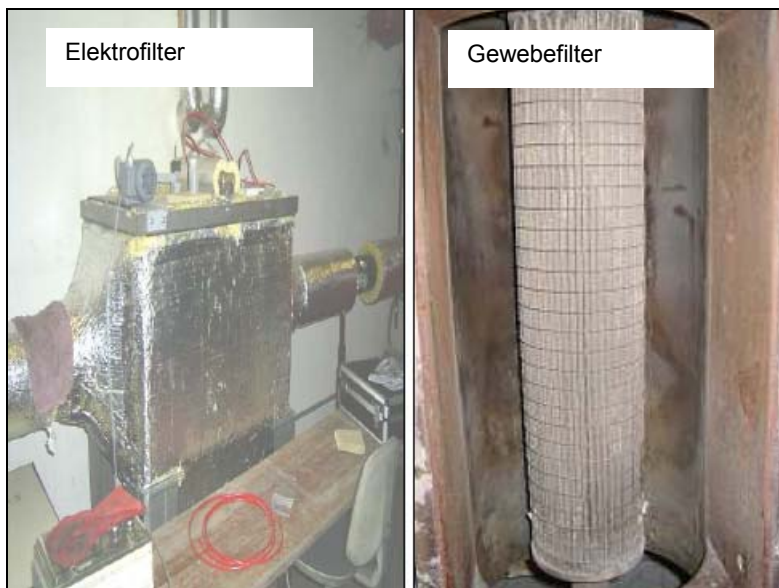
Abbildung 68: Filtertechnik zur Rauchgasreinigung 269
