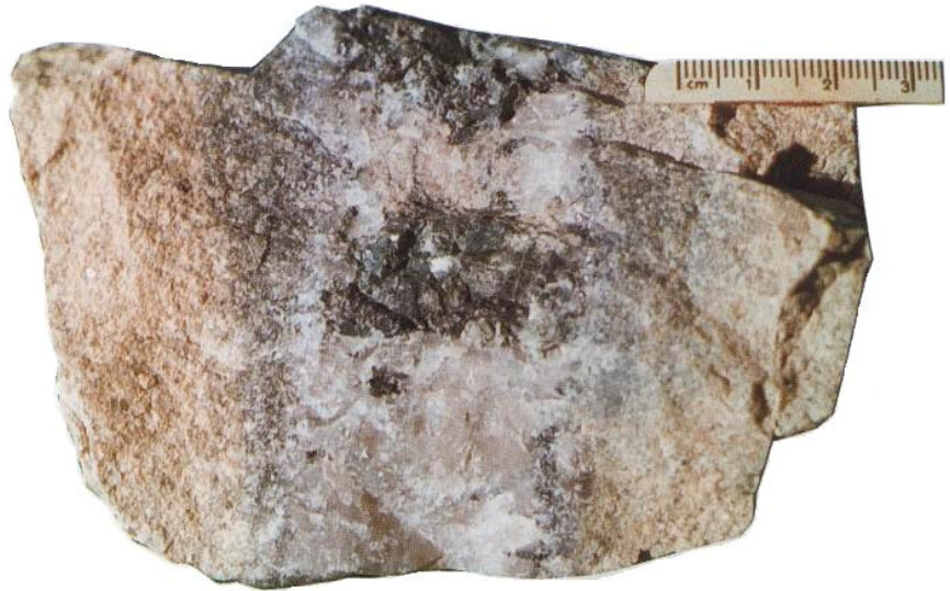
Abb. 74: Quarztrüm mit Wolframit, Molybdänit, Kassiterit, Li-Glimmer; Triplit; Nebengesteinsvergreisung gering; 113 m-Sohle, Str. 26 SW bei 3,5 m, Firste Foto: LfUG
