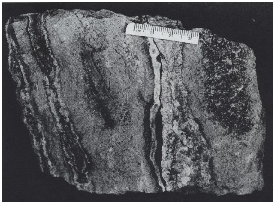
Abb. 82: "Roter Fall", mehrere Paralleltrümer mit Feldspat, Keilquarz, Hornstein, Hämatit, Nebengestein (Granit), zersetzt und teilweise vergreist (rechts oben), Pinge Geyer. Foto: LfUG
