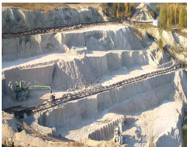
Abb. 67: Tagebau Gröppendorf, Kaolingewinnung mit Schaufelradbagger
