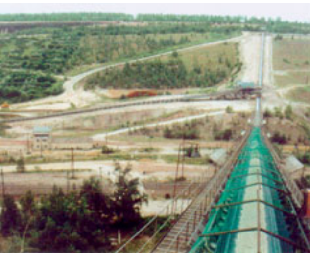
Abb. 5-2-42: Querung Niederfahrt 1:36 mit Gurtbandförderer 3 im Tagebau Espenhain
