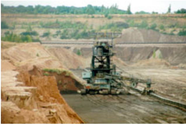
Abb. 5-2-56 : Bagger 1547 SRs 1000 bei der Kippenrückge-winnung im Tagebau Espenhain
