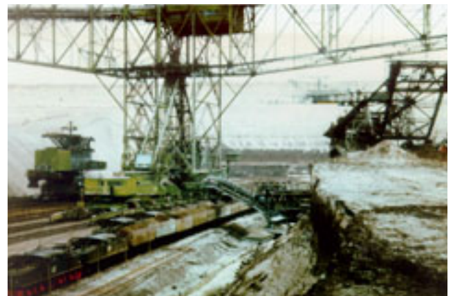
Abb. 5-2-32: 1435-mm-Zugbetrieb im Mittelabraumschnitt unter der Hauptbrücke des Brückenverbands Espenhain
