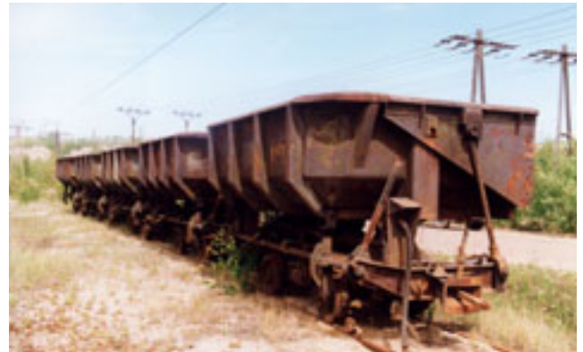
Abb. 5-6-3: 6-m 3 -Kastenkipper (Foto: KIRCHHÜBEL)
