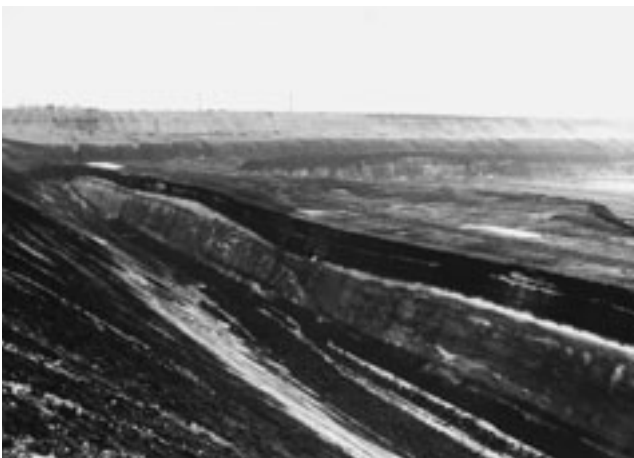
Abb. 2-3-8: Tagebau Zwenkau, Brückentiefschnitt am 09.02.1987 – Sondertechnologie mit Durchschneiden des nicht bauwürdigen Flözes IV im Bereich der Flussandzone
