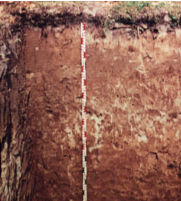
Abb. 3-1-2: Parabraunerde-Pseudogley aus kiesführendem Löß über kiesführendem Moränenlehm bei Greifenhain (Foto: M. WÜNSCHE)
