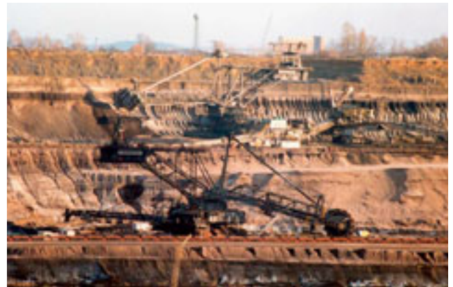
Abb. 6-2-8-3: Bagger 1528 SRs 2000 bzw. 1552 SRs 2000 im 1. und 2. Schnitt (1998) (Foto: Archiv MIBRAG mbH)
