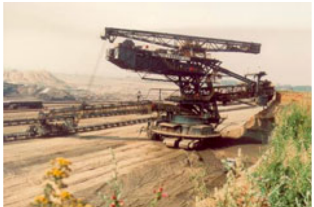
Abb. 5-2-39: Bagger 1522 SRs 1300 im 1. Abraumschnitt Tagebau Cospuden
