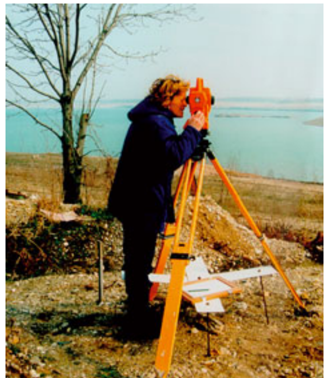
Abb. 7-3-4: Tagebauvermessung mittels Totalstation auf der Basis eines Aufnahmepunktes; Tagebau Cospuden
