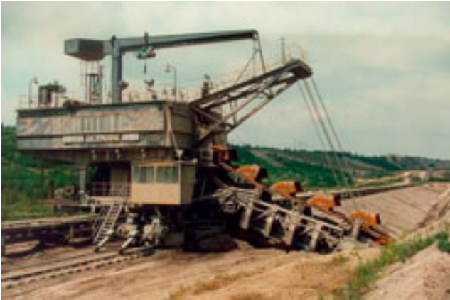
Abb. 5-2-41: Grabenschöpfer 1317 G 1600 Tagebau Espenhain
