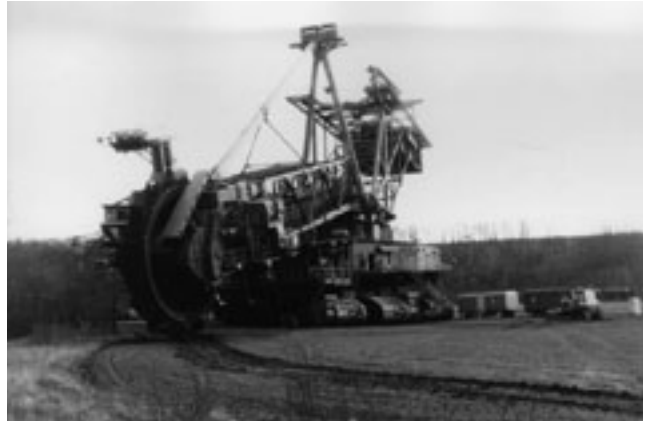
Abb. 5-2-45: Transport des Neubaugeräts 1552 SRs 2000 zum Einsatzort
