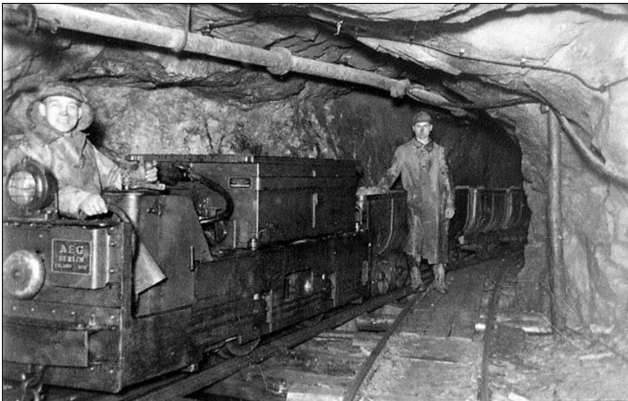
Zug mit Akku-Lok um 1940 auf der 200 m Sohle. Digitalisat: Sammlung H. Herklotz
