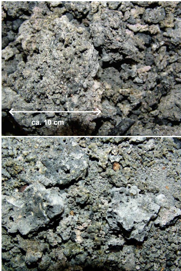
Abb. 33: Heupelletaschen (1. Variante ohne Zuschlagstoffe) aus den zwei Kleinf Feuerungsanlagen; oben: aus dem Biomassekompaktkessel, unten: aus dem Pelletkessel
