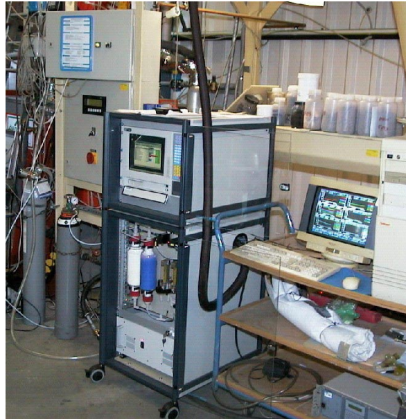
Abb. 28: Kesselprüfstand des Instituts für Luft- und Kältetechnik gGmbH Dresden (ILK)
