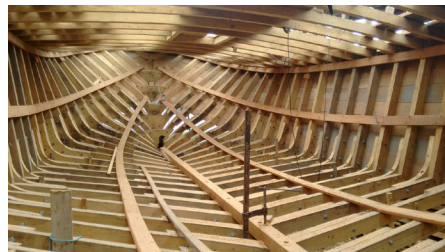
Figura 1: Armação de uma embarcação de médio porte, feita em estaleiros da região bragantina.
