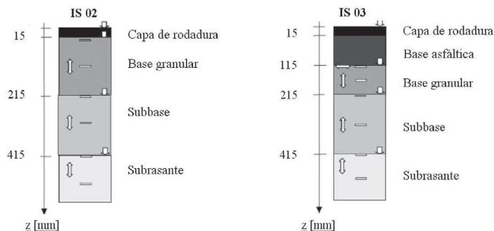
**Figura 2.** Estructuras de pavimento ensayadas en un HVS [24, 25, 49].
