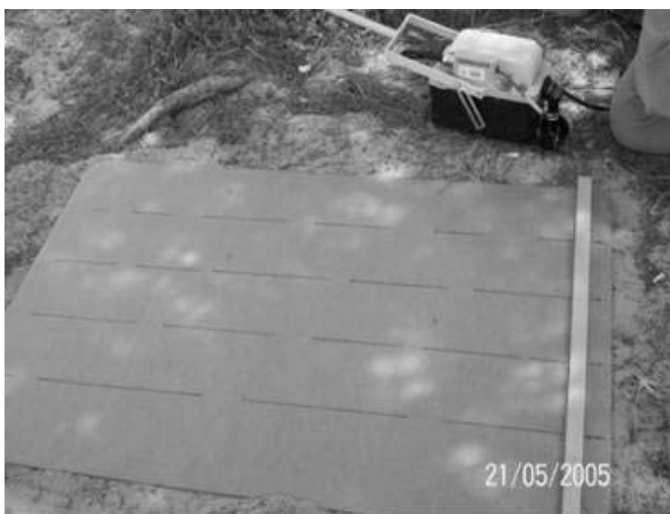
Figura 4. Lámina de cartón marcada con los perfiles y antena de 1000MHz usada para tomar registros.
