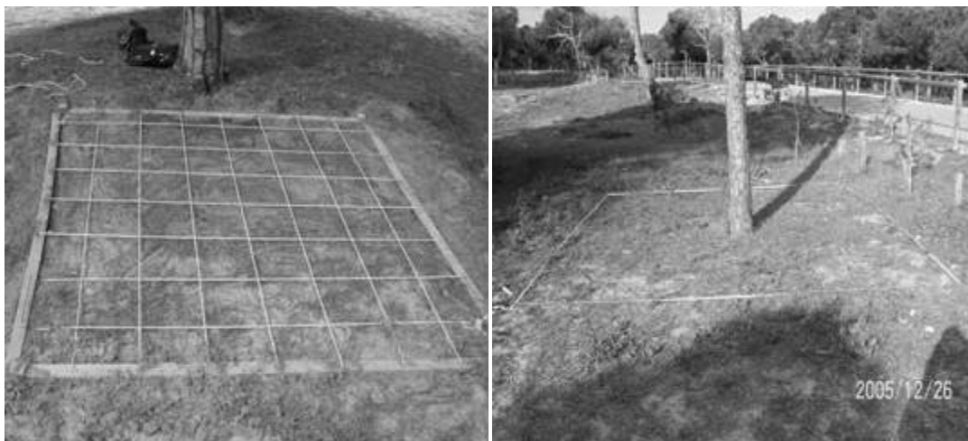
Figura 3. Preparación de las mallas que sirven de referencia al desenterrar las raíces y al mismo tiempo de guía para la antena de GPR.
