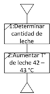
Figura 11. Diagrama PFC de la operación calentar leche
