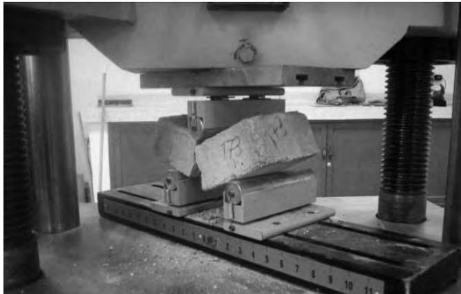
**Figura 3.** Ensayo de flexión en ladrillos
