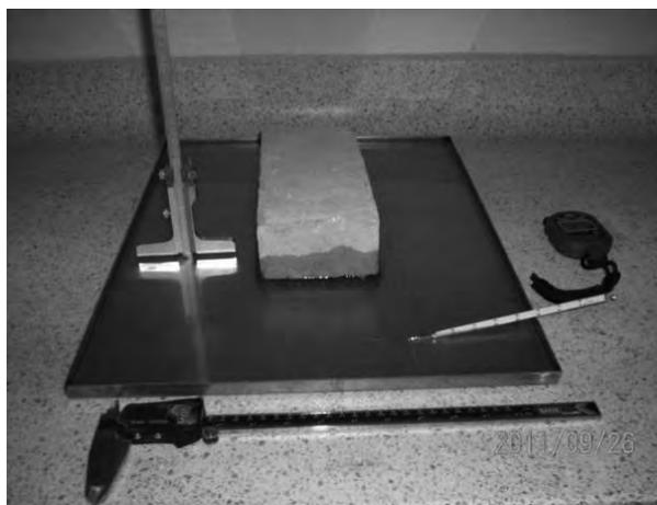
**Figura 4.** Ensayo de Tasa inicial de absorción en ladrillos.
