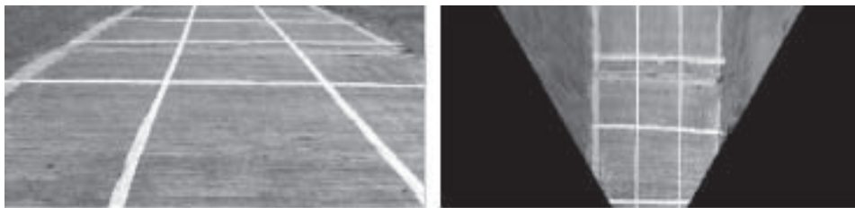
Figura 8. Transformación geométrica: en la parte izquierda de la imagen, se puede ver la imagen original que ven las cámaras. La parte derecha representa la utilización del subprograma y los resultados al aplicar la IPM.
