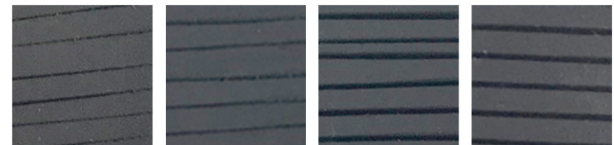
図11 杖先ゴムに加工した溝 (左から:溝幅0.25mm, 0.3mm, 0.6mm, 0.8mm)
