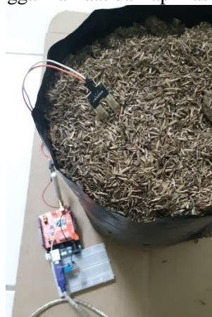
Gambar 11. Pemasangan sensor di media tanam
