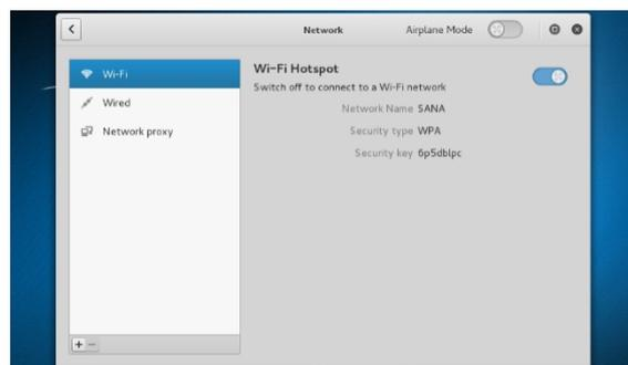
Gambar 1. Mengaktifkan *wireless hotspot* pada sistem operasi *kali linux*
