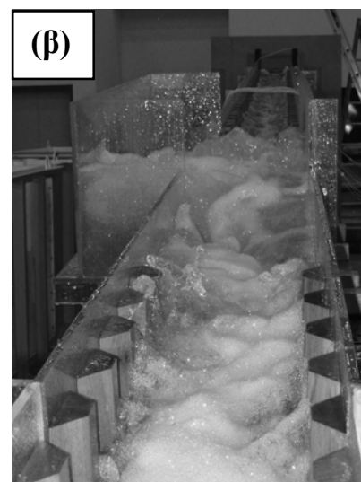
Εικόνα 1. (α) Άποψη της λεκάνης καταστροφής ενέργειας του αρχικού σχεδιασμού κατά τη Δοκιμή 1 (ροή από δεξιά προς τα αριστερά). (β) Άποψη της διαμόρφωσης της ελεύθερης επιφάνειας κατάντη της λεκάνης καταστροφής ενέργειας κατά τη Δοκιμή 1.
