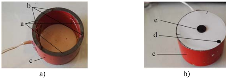
3.7 pav. Cilindrinis pjezorobotas su trimis kontaktiniais taškais:
