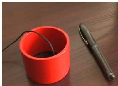
1.5 pav. Cilindrinio keitiklio prototipas (Bansevicius 2007)
