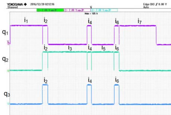
4.12 pav. Realus signalo pjezoroboto segmentuose oscilograma.
