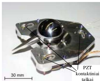
1.15 pav. Pjezoroboto MINIMAN judėjimo plokštumoje mechanizmai – PZT kontaktiniai taškai (Woern H. et al. 2000)
