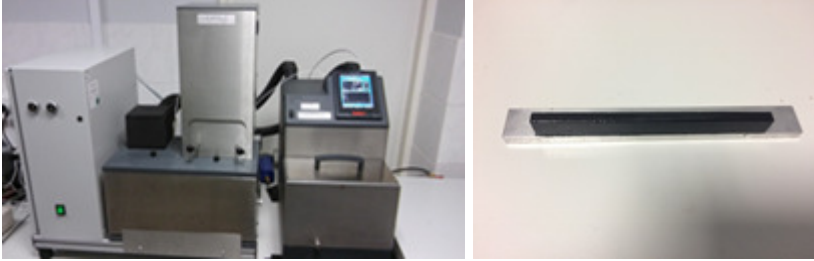
2.14 pav. Bitumo kritinės žemiausios temperatūros nustatymo įranga ir bandinys Fig. 2.14. Equipment and specimen of bitumen critical low temperature test
