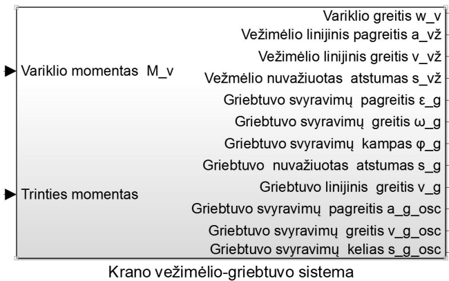
3.26 pav. Vežimėlio ir kėlimo mechanizmo mechaninės posistemės blokas Fig. 3.26. Block of trolley and lifting mechanism mechanical subsystem
