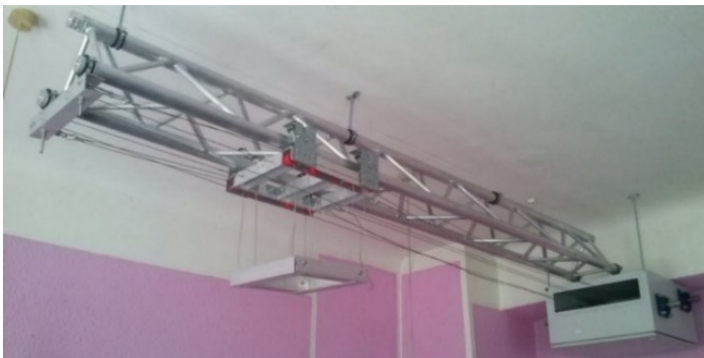
3.11 pav. Krano griebtuvo ir kėlimo mechanizmo laboratorinis prototipas Fig. 3.11. The laboratory prototype of crane spreader and lifting mechanism
