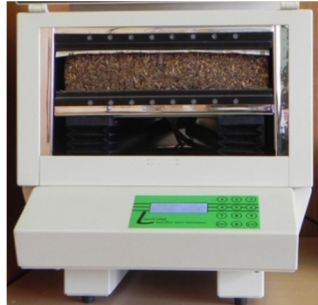
2.5 pav. Šilumos laidumo koeficiento nustatymo įranga LaserComp FOX 304 Fig. 2.5. Equipment of thermal conductivity measurement LaserComp FOX 304
